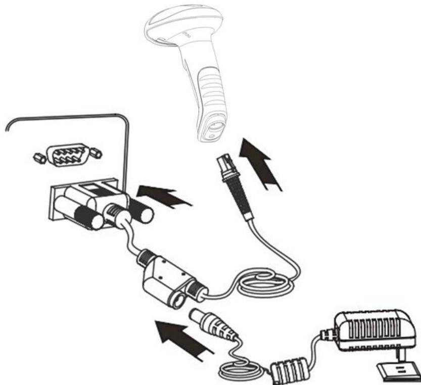
1. 将 RS-232 数据线的设备接口端（RJ 45 接口）与 HR22 相连；
