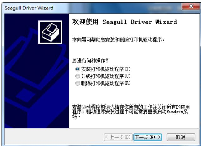
7. 在Seagull驱动程序精灵提示窗口上，选取第一项「安装即插即用打印机的驱动程序」然后按「下一步(N)」
